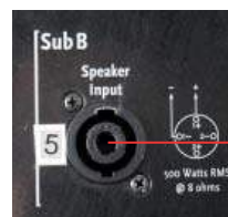
Rückansicht passive Bassbox (benötigt keinen Strom!)
