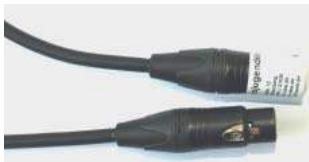
4x XLR-Kabel für Verbindung Mischpult zu aktiven Toppteilen (1 & 2) und Verbindung aktive Toppteile und aktive Bassboxen (3 & 4)
